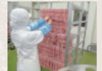
まんべんなくスモークできるように間隔を空けて吊るします
